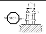
MULTIFASTER üblicherweise an Hydraulik-Schlauchleitungen montiert. Aus diesem Grunde ist es stets notwendig, bei der Montage zwei Schraubenschlüssel zu verwenden, um ein Drehen der Kupplungen während der Montage zu verhindem.
